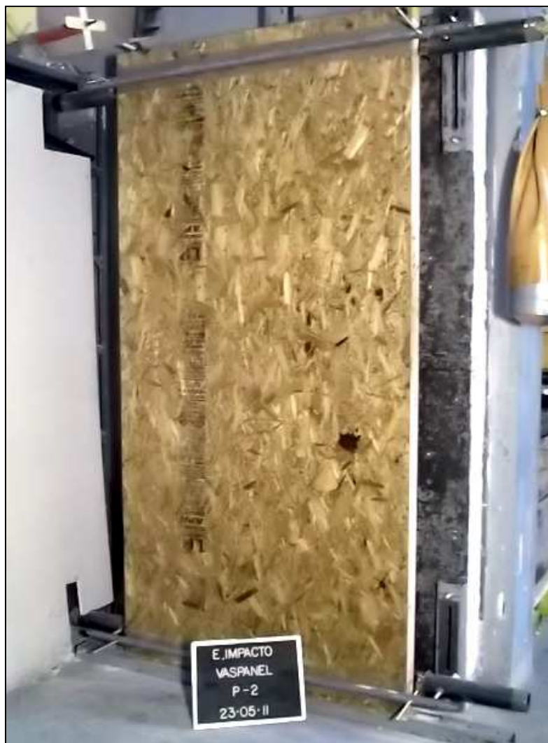
Foto 2. Montaje del ensayo de impacto de cuerpo blando al panel (típico).
