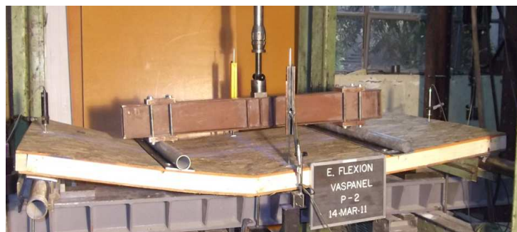
Fotos 5 y 6. Modo de falla de la muestra Nº 2.
