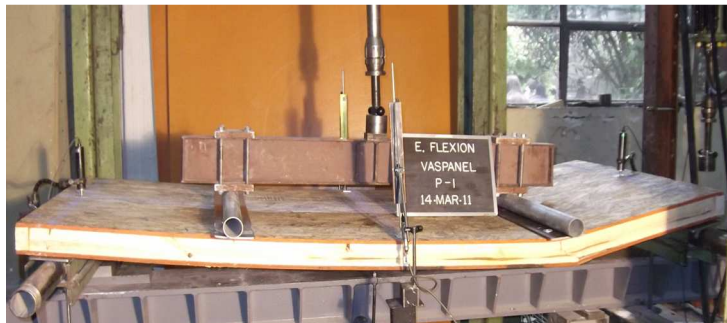
Fotos 3 y 4. Modo de falla de la muestra Nº 1.
