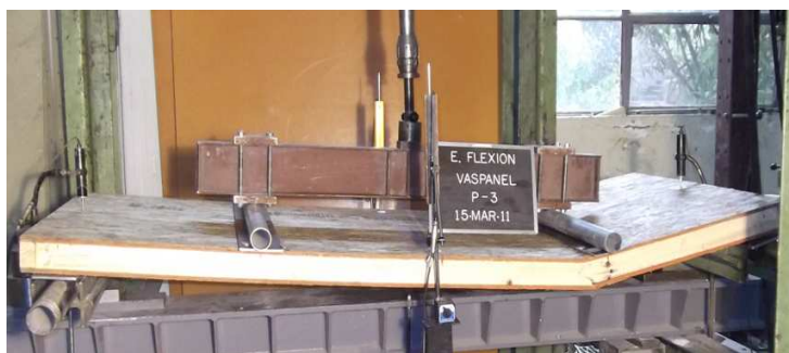
Fotos 7 y 8. Modo de falla de la muestra Nº 3.
